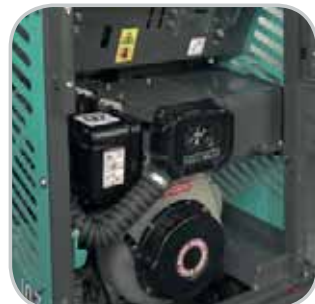
LARGE OUVERTURE DU CAPOT MOTEUR POUR UN ENTRETIEN FACILITÉ (DIESEL)
