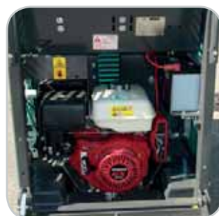
LARGE OUVERTURE DU CAPOT MOTEUR POUR UN ENTRETIEN FACILITÉ (ESSENCE)
