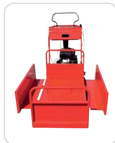
PLATEAU DE CHARGEMENT AJUSTABLE JUSQU'À 1 000 X 740 MM
