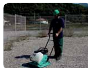
FRÉQUENCE DE VIBRATION ÉLEVÉE Elle réduit instantanément le frottement entre les particules et permet une utilisation polyvalente de la machine.
